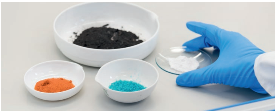
Aurubis gewinnt aus Schwarzer Masse (im Foto oben) neben Nickel (unten Mitte) auch Kobalt (unten links), Lithium (unten rechts) und Graphit zurück.
